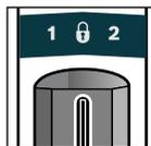
Tombol untuk menghidupkan dan mematikan **8** memblok dan perkakas listrik dilindungi terhadap penghidupan yang tidak disengaja.
