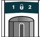
Công tắc Tắt/Mở 8 bị chặn lại và máy vẫn an toàn, không bị khởi động do vô ý chạm phải.
