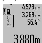
Perhatikanlah supaya dasar pengukuran dari pekerjaan mengukur (misalnya pinggiran belakang dari alat pengukur) pada semua pengukuran satu per satu dalam rangka satu pengukuran, berada tepat pada tempat yang sama.
