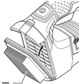
8. 本体下部の溝にダストカップ⑦のフックを差し込み、ダストカップ⑦を矢印の方向に閉じます。
