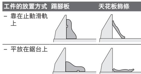
接下來可以根據側邊條的寬度，選擇需拉動的鋸切方式或無需拉動的鋸切方式。
