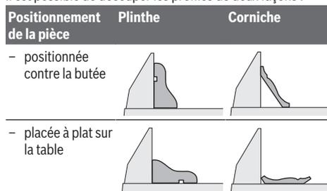
Les coupes peuvent par ailleurs être effectuées avec ou sans mouvement radial suivant la largeur du profilé.
