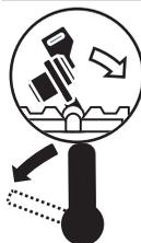
Para ajustar a faixa de ângulo de meia-esquadria vertical direita, o braço da ferramenta deve primeiro ser inclinado ligeiramente para a esquerda e depois a alavanca de ajuste deve ser pressionada para a esquerda.
