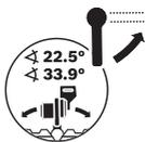
Untuk mengatur sudut mitre standar vertikal (22,5° dan 33,9°), tuas pengunci harus dilepaskan ke atas.
