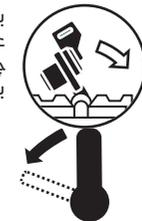
برای تنظیم کل محدوده زاویه مورب عمودی تا  $47^\circ$  (سمت چپ و راست) باید دکمه قفل به داخل فشار داده شود.
