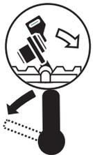
Pour régler des angles d'inclinaison dans toute la plage jusqu'à 47° (vers la gauche ou vers la droite), il faut appuyer sur le bouton de blocage.
