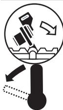
若要調整右側的垂直斜鋸角範圍，必須先將機臂稍微往左傾斜，然後將調整桿向左推。
